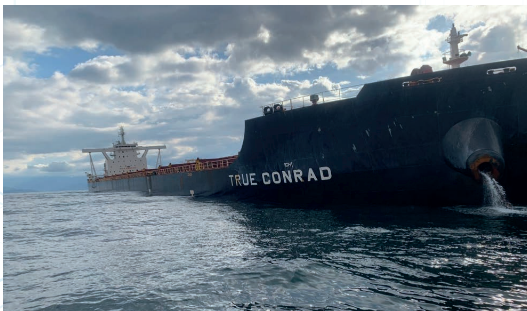
Figura 6: Navio fundeado com significante banda e trim, fim verificar condições de estabilidade e segurança Fonte: Acervo equipe de inspeção naval, 2024.
